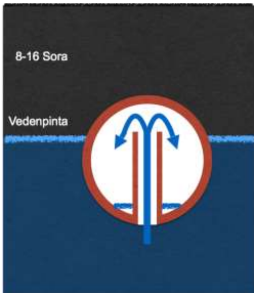
Kuva 1. Painovoimaerottelulla toimivan salaojaputken toimintaperiaate. TehoDrain / PeTec Engineering Oy.
